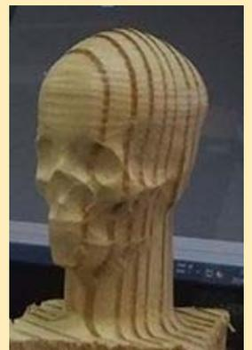
棒状の刃物がスイングしながら、材料先端部から側面へと加工
