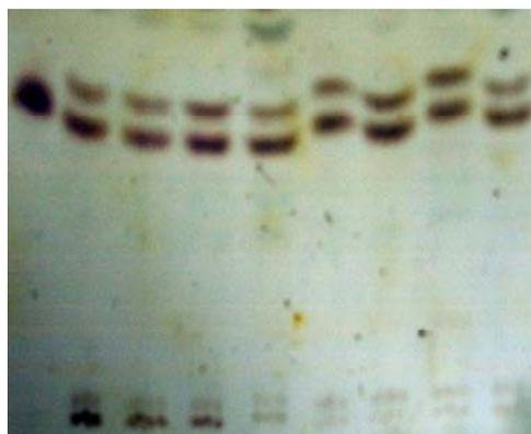
第1図 TLCによるタモギタケのセラミド検出
