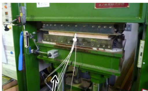
熱電対（接着層の温度を計測）
