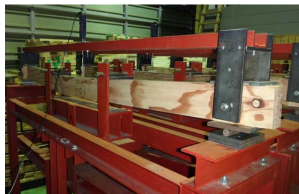
クリープ破壊の一例
