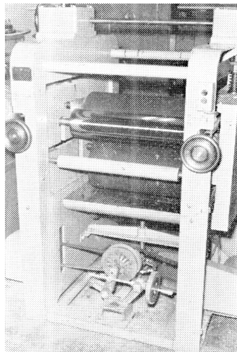
グルースプレッター Photo 6 Glue spreader
