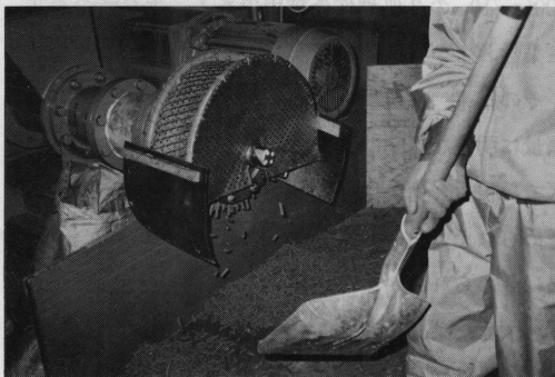
第1図 連続混合成形装置と製品ペレット
