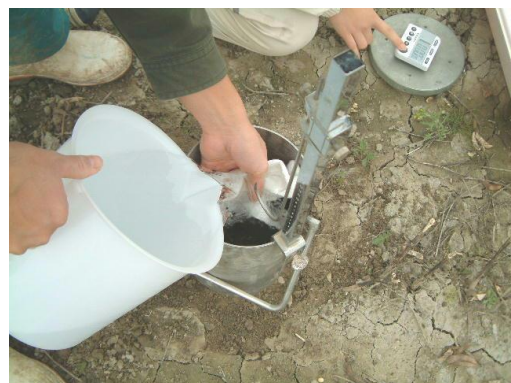
シリンダーへの注水状況
