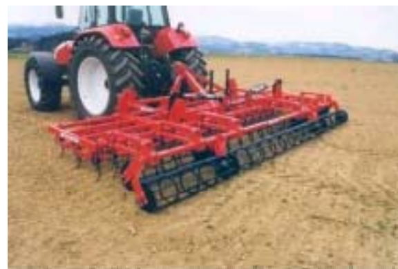
図1-4-4 コンビネーションハローでの砕土 整地作業
