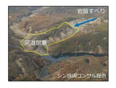
・深い岩盤すべりは、層構造の 発達した地質で発生し、地層 の傾斜方向に沿って移動
