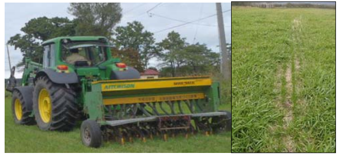
写真2 追播機による低コスト補修と補修跡
