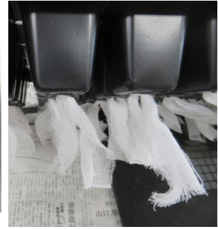
写真2 底面吸水用不織布とガーゼの設置 (左：上部からの画像、右：側面からの画像)
