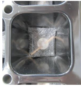
写真2 底面吸水用不織布とガーゼの設置 (左：上部からの画像、右：側面からの画像)
