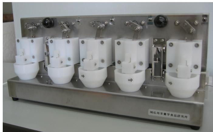
写真1 試験用小型もち搗き機
