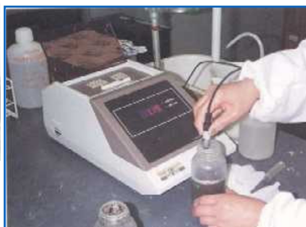
電気伝導度の測定
