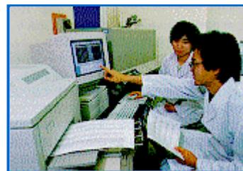
このDNAシーケンサーは従来のラジオアイソトープの代わりに蛍光色素を用いて、レーザーで読みとった信号をオンラインのコンピュータで解析してシーケンスを決定する装置で、一般の実験室で使用できます。一度に24サンプルの処理が可能で約10,000塩基のシーケンスを決定します。
