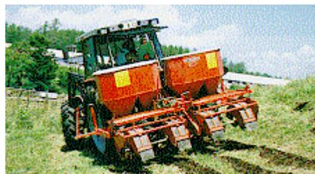
傾斜草地用の簡易更新作業機(開発中)の実験風景
