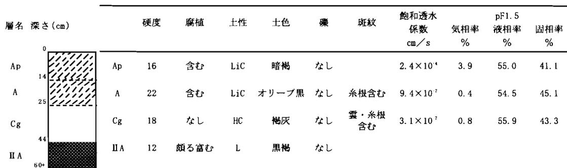
図27. 試験圃場の土壌断面
