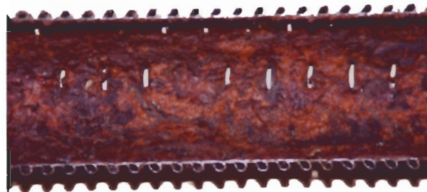
写真2-1-1 暗渠管内への土砂及び酸化鉄の沈積例
