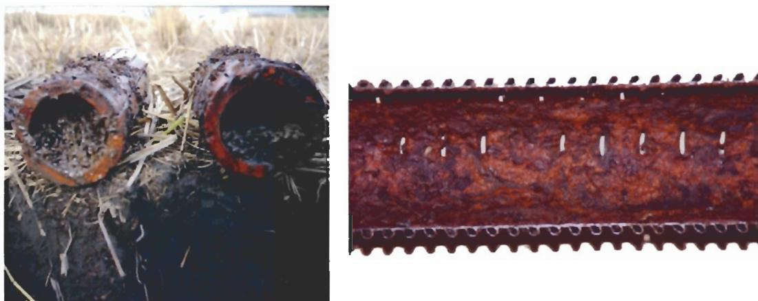
写真2-1-1 暗渠管内への土砂及び酸化鉄の沈積例
