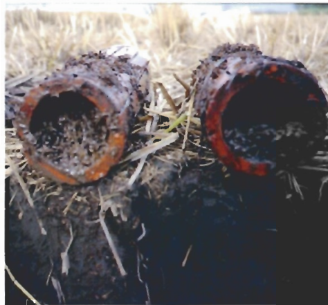
写真2-1-1 暗渠管内への土砂及び酸化鉄の沈積例
