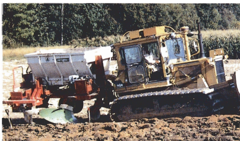
写真3-1-1 カルチタイン式心土改良耕の施工状況
