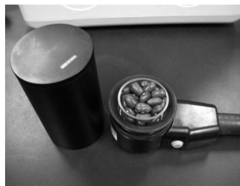
写真 フルーツセレクターによる近赤外スペクトル測定の様子
