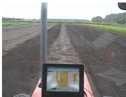
図2 前面に取り付けた液晶タッチパネル（8.4inch、吸着パッドで取り付け可能）
