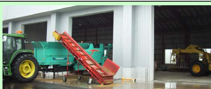
ラッパー体型細断型ロールベアラを使った試験では1時間で18個のロールを作りました。
