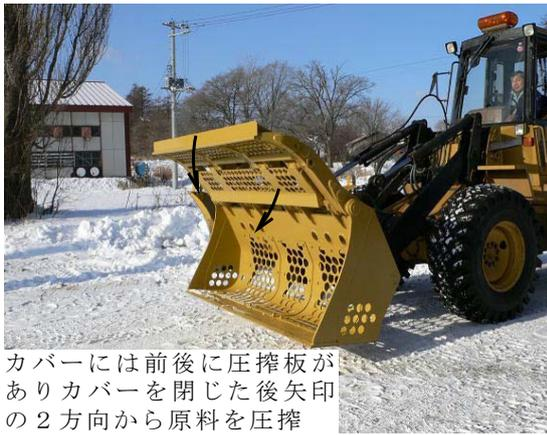
カバーには前後に圧搾板がありカバーを閉じた後矢印の2方向から原料を圧搾
