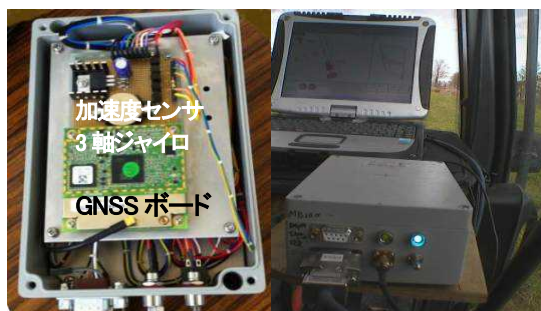
図1 開発したハイブリッドGPS 航法装置内部（試験機）とトラクタ運転席横に取り付けた装置
