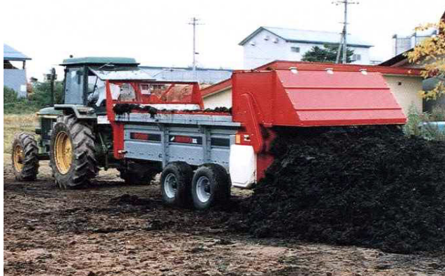
堆肥堆積運搬車による堆積作業風景
