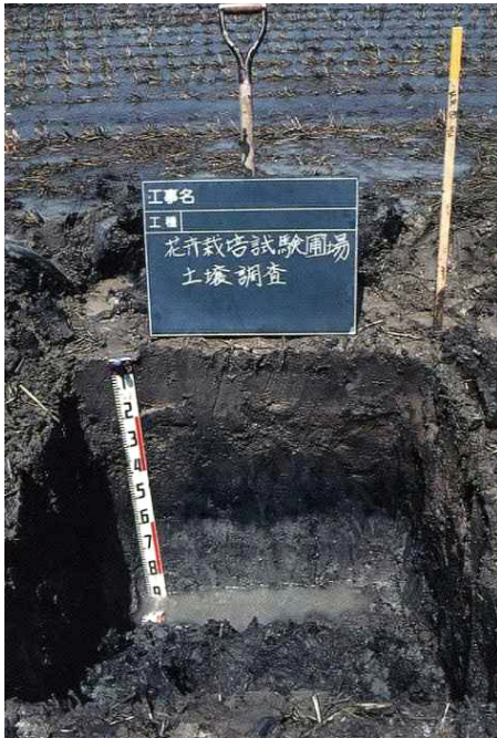
排水不良であるグライ土の施工前の土壌断面
