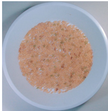
従来の選別技術 (粒厚選別 2.00 mm) 選別歩留：72.3%、検査等級：3 等 (下) 整粒割合：81.8%
