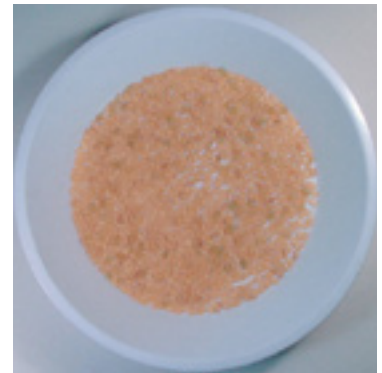
新しい選別技術 (粒厚選別 1.90 mm と色彩選別) 選別歩留：83.6%、検査等級：1 等 (中) 整粒割合：84.6%
