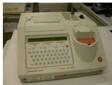
磁性粒子を用いた生物発光法により 異常プリオン蛋白質を検出するルミノメーター
