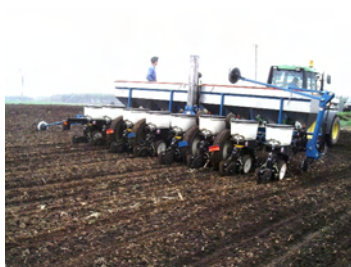
帯広市内コントラクターが導入した 不耕起用は種機（8畦タイプ）での は種作業
