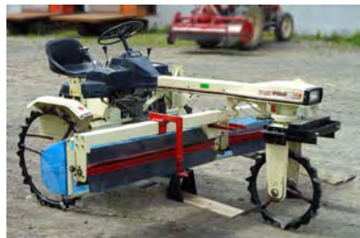
↑ タイン型除草機 水田表層をタイン（熊手のような爪）が攪拌し、除草をします。株間にも畝間にも高い効果を発揮します。
