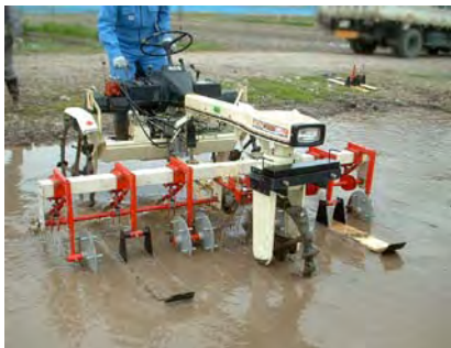
↑ タイン型除草機 水田表層をタイン（熊手のような爪）が攪拌し、除草をします。株間にも畝間にも高い効果を発揮します。
