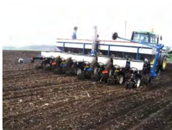
帯広市内コントラクターが導入した 不耕起用は種機（8畦タイプ）での は種作業
