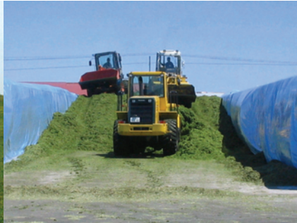
バンカサイロにおける ホイールローダによる 拡散・踏圧作業
