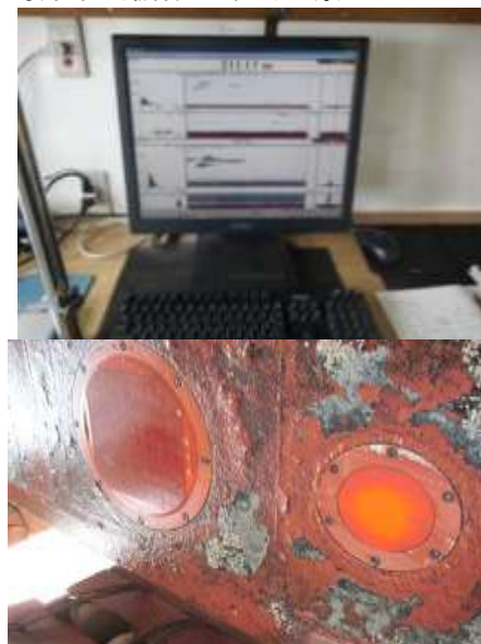
計量魚群探知機の制御部(上) 船底に設置されたセンサー(下)と、実際の調査での断面図(右)
