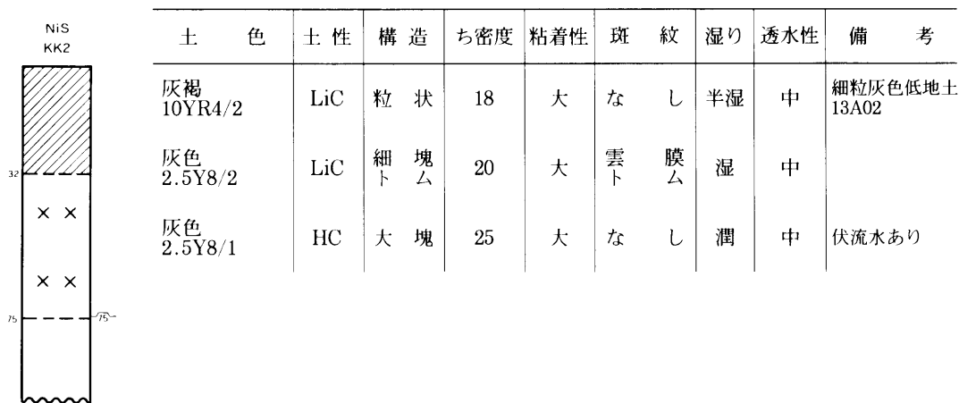
土壌断面の概要と柱状図（試坑地点 No.KK2 旭川市江丹別西里 畑）
