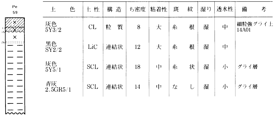
土壌断面の概要と柱状図 (試坑地点 No.59 東旭川町 水田)
