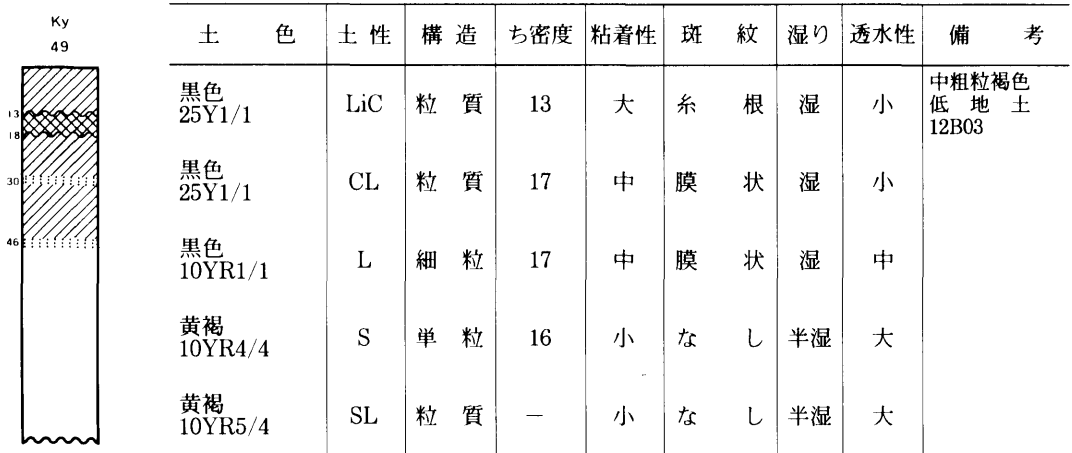
土壤断面の概要と柱状図（試坑地点 No.49 東旭川町 水田）
