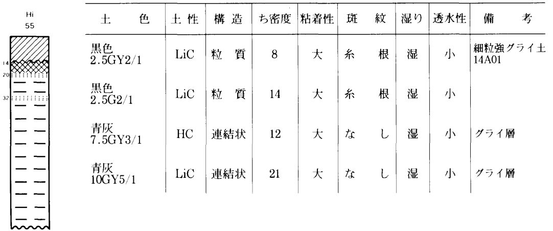
土壤断面の概要と柱状図（試坑地点 No.55 東旭川町 水田）
