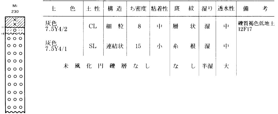
土壌断面の概要と柱状図（試坑地点 No.230 東旭川町瑞穂 水田）
