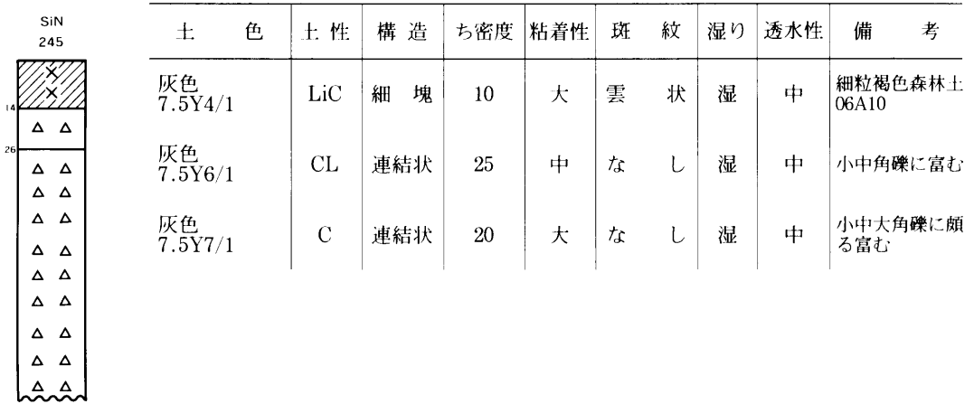
土壌断面の概要と柱状図（試坑地点 No.245 東旭川町下南部 水田）
