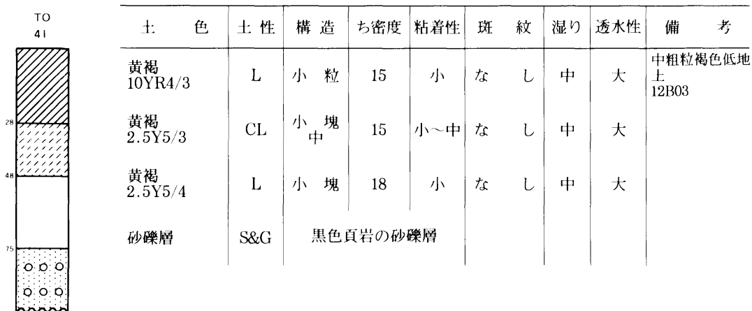
土壤断面の概要と柱状図（試坑地点 No.41 畑）吉田福太郎宅地先
