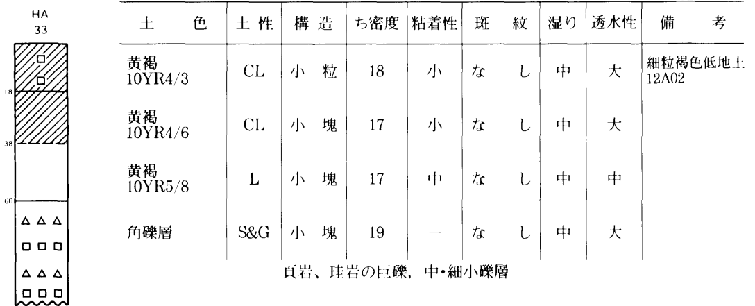
土壌断面の概要と柱状図（試坑地点 No.33 牧草地）工藤宅地先
