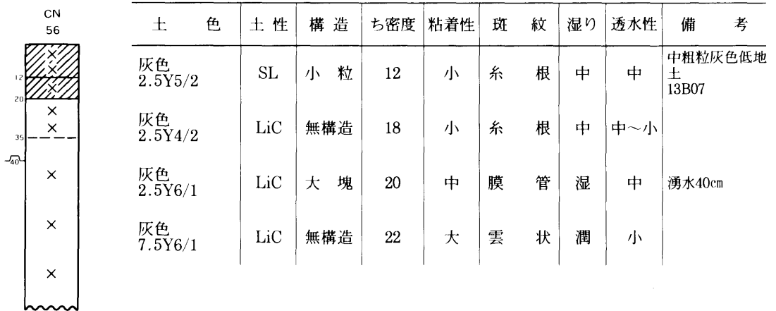
土壤断面の概要と柱状図（試坑地点 No.56 水田）
