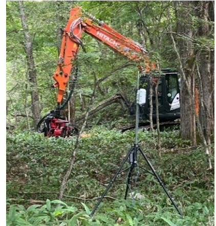
写真1 通信環境を整備した山林内でのICTハーベスタの試行
