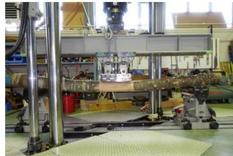
写真1 曲げ強度試験の様子
