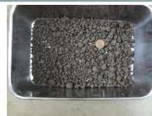
燃焼灰の造粒技術 (燃焼灰のハンドリング 向上・ドローン等を用いた 散布への応用)
