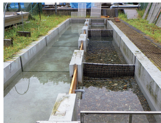
サケの産卵を観察するための実験水路 (砂利を敷き詰めた屋外水路)
