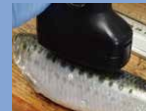
非破壊脂質測定器によるマイワシの脂質測定
