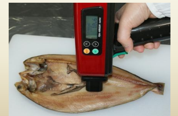
近赤外分光器によるホッケ一夜干しの脂質含有量測定
