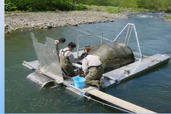
スクリュートラップを用いた降河幼稚魚調査
