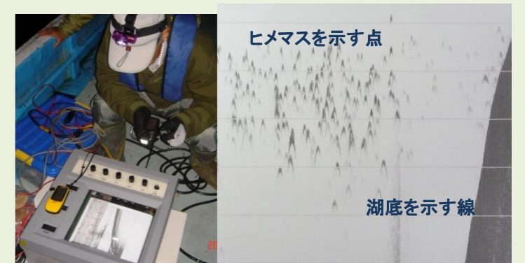
魚群探知機によるヒメマス資源量調査(左)とその映像(右)
