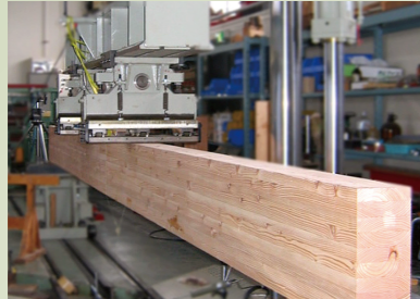
実大材の曲げ強度試験
