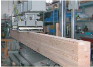
実大材の曲げ強度試験
