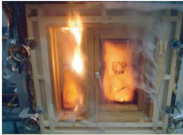
木製サッシの防火試験
