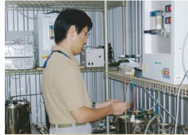
小型チャンバーを用いた VOC 測定
