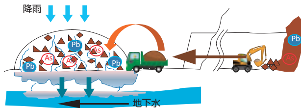
掘り出した土砂が地下水の汚染を招く場合もある (Asはヒ素、Pbは鉛を表しています)。
