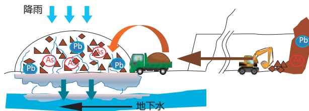
掘り出した土砂が地下水の汚染を招く場合もある (As はヒ素、Pb は鉛を表しています)。
