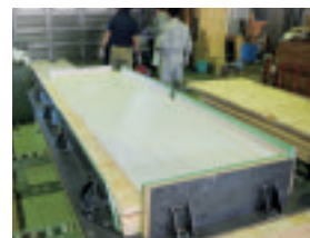
カラマツ CLT の実大製造試験
