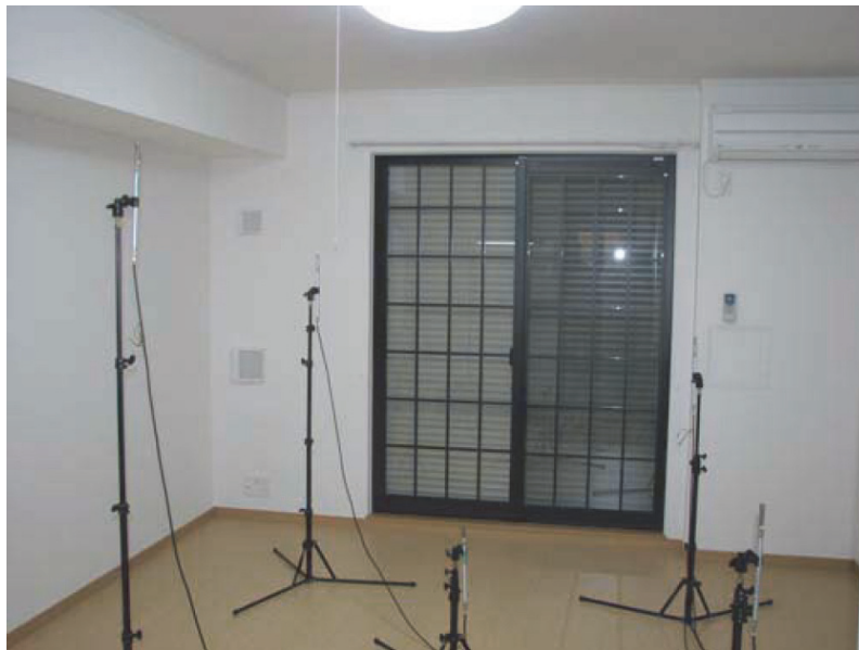
写真 4-2 床衝撃音レベルの計測の様子
