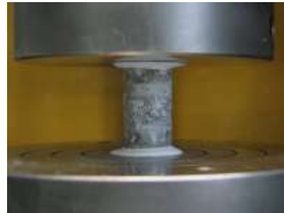
小径コアの圧縮強度試験
