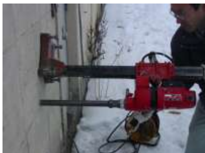
固定式ドリルによる小径コアの採取
