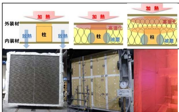
図 1-1 実験に基づく防火性能の検討
