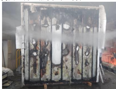
試験体加熱面（終了後）
