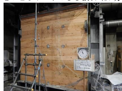
試験体裏面目地部より発煙 (57分)
