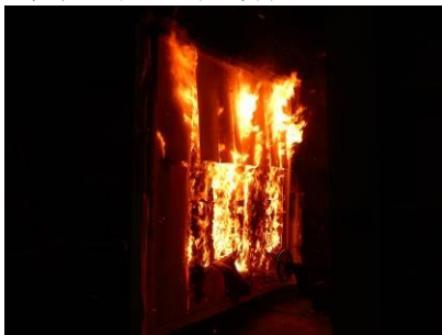
試験体加熱面（終了後）
