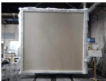
試験体加熱面（試験前）
