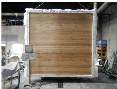
試験体加熱面（試験前）
