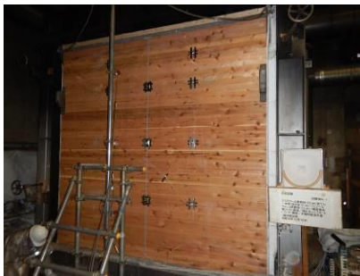
試験体非加熱面（試験前）
