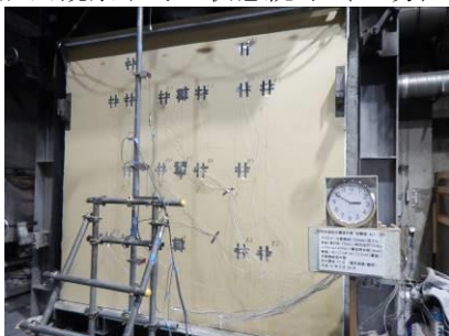
試験体非加熱面（終了時）
