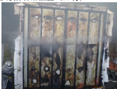
試験体加熱面（終了後）
