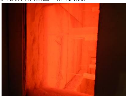
ひび割れ部の幅広がる (23分)
