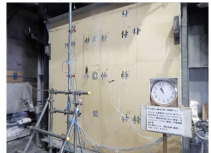
柱が座屈する (×非損傷性) (57分)
