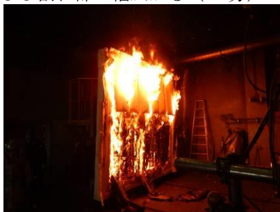
試験体加熱面（終了後）
