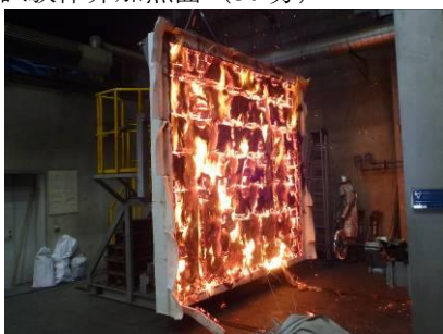
試験体加熱面（終了後）
