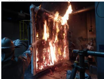
試験体加熱面（終了後）
