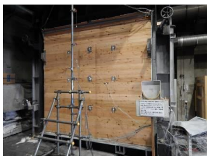
試験体非加熱面（試験前）
