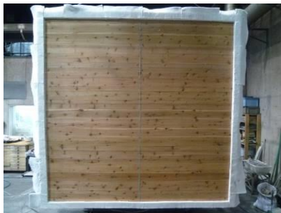
試験体加熱面（試験前）
