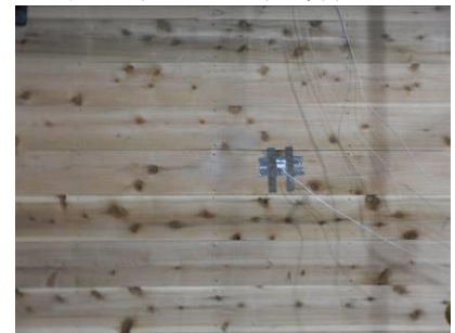
試験体裏面目地部より発煙（51分）
