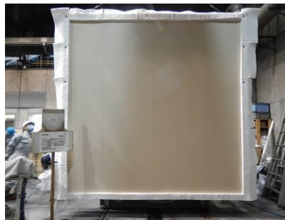
試験体加熱面（試験前）
