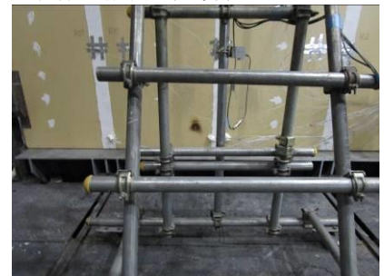
試験体裏面、燃え抜け（53分）
