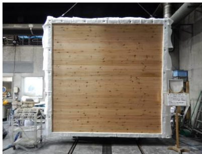
試験体加熱面 (試験前)
