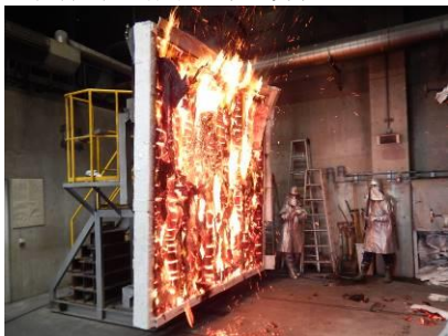
試験体加熱面（終了後）
