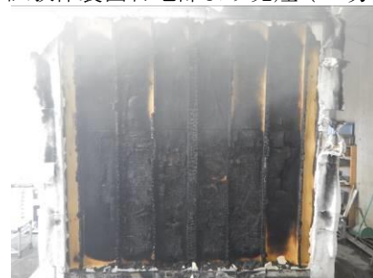
試験体加熱面（終了後）
