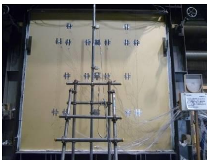
試験体非加熱面（試験前）
