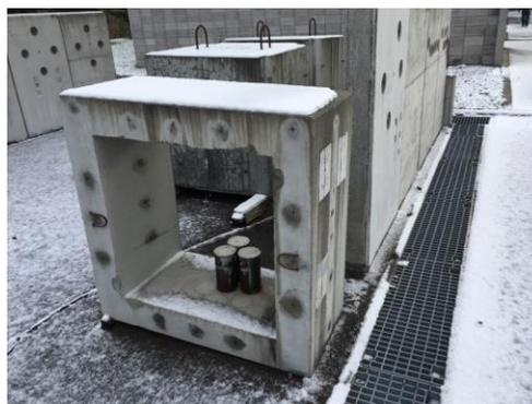
写真 3.2.1 屋外暴露試験体の設置状況 (旭川)
