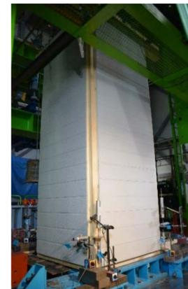
写真1 直交壁の加力実験
